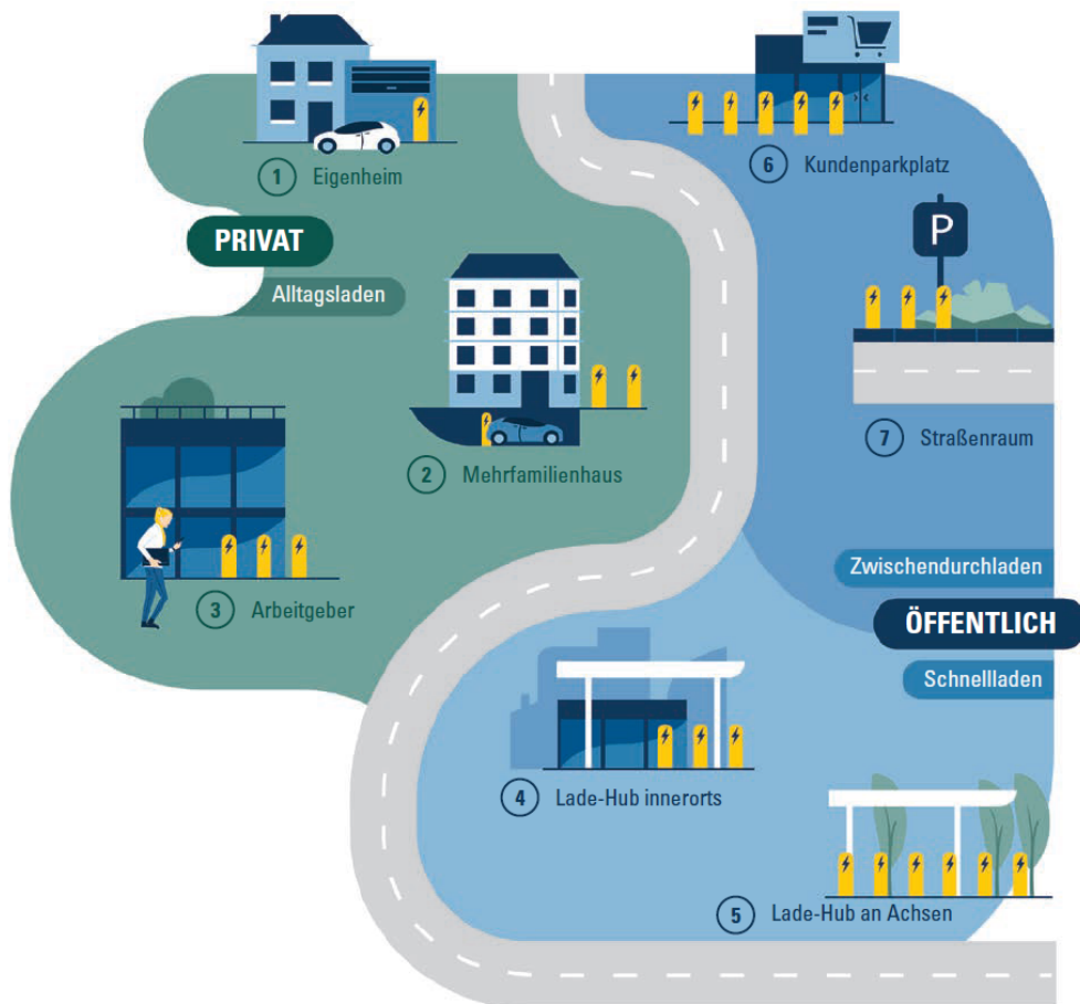
Abbildung 4.1: Übersicht unterschiedlicher Use-Cases für das Laden eines Elektrofahrzeugs [15].
